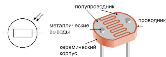
*Фоторезистор – это полупроводниковый резистор, действие которого основано на фоторезистивном эффекте.*
