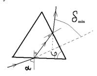
Поверните держатель с призмой таким образом, чтобы закрытая держателем грань была обращена к боковому полукруглому экрану, а входная грань призмы была перпендикулярна лучу лазера. Запишите положение призмы  $\alpha$   $_0$  по угловой шкале её держателя. Затем поверните призму против часовой стрелки так, чтобы преломленный призмой луч попал на боковой экран. Продолжая поворачивать призму против часовой стрелки и наблюдая прошедший луч, отметьте такое положение призмы, при котором
